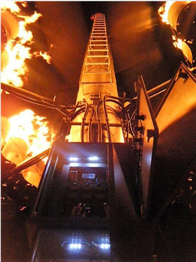
El calefactor central consta de ocho cámaras de combustión dispuestas en torno a la torre de la máquina de viento, capaces de producir hasta 1,7 MW de calor para subir la temperatura del flujo de aire que desplaza la máquina. Las máquinas con calefactor central son capaces de combatir heladas advectivas sacrificando en algunos casos, según la duración de la helada, radio de cobertura.
