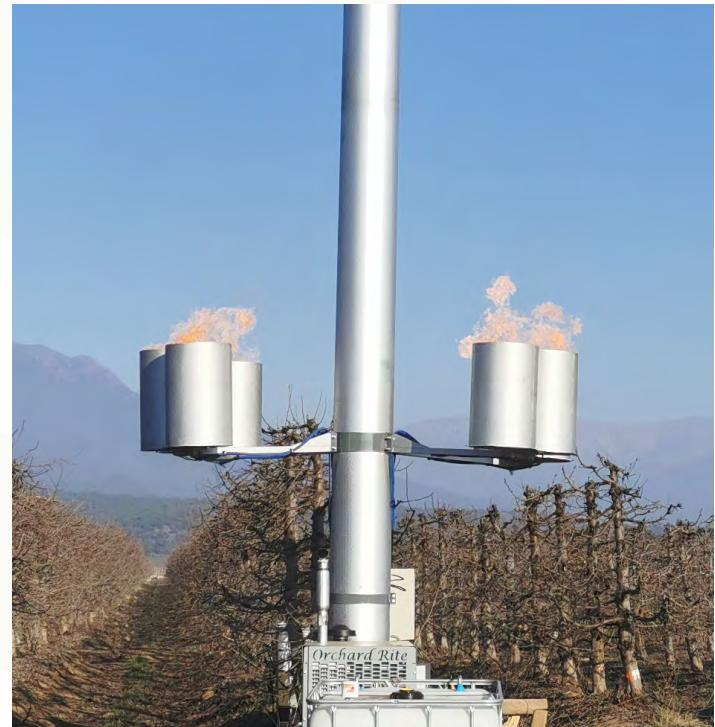
La principal ventaja del calefactor central es que el calor se introduce directamente bajo la máquina de viento, donde se eleva por densidad, y así se aprovecha el flujo de aire de la máquina para distribuir ese calor por el predio. Esta es una forma mucho más efectiva y eficiente de aportar el calor necesario para control de heladas polares o heladas radiativas severas.
